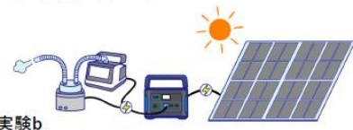
実験b 蓄電池をソーラーパネル充電しながら 人工呼吸器と加温加湿器を接続し運転
