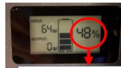
蓄電池のディスプレイに表示されている 数値で電池残量を確認
